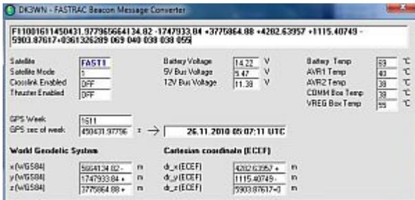
Esta pequeña herramienta está diseñada para decodificar la baliza BTEXT de FAST1 y FAST2. Simplemente copie la cadena de baliza recibida (siempre comienza con F1 o F2) en la ventana superior y se muestran los valores decodificados. Es importante que la longitud de la baliza sea de 122 caracteres.
